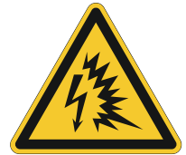
W042 Warning; Arc flash
